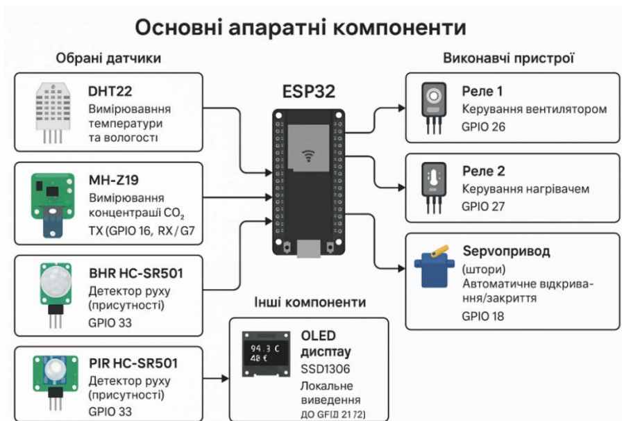
Рис. 2. Апаратні компоненти, з'єднані з ESP32
